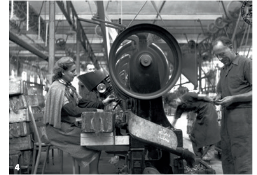
4. Sertissage sur presse verticale, 1952. CAA Crimping on a vertical press, 1952.
