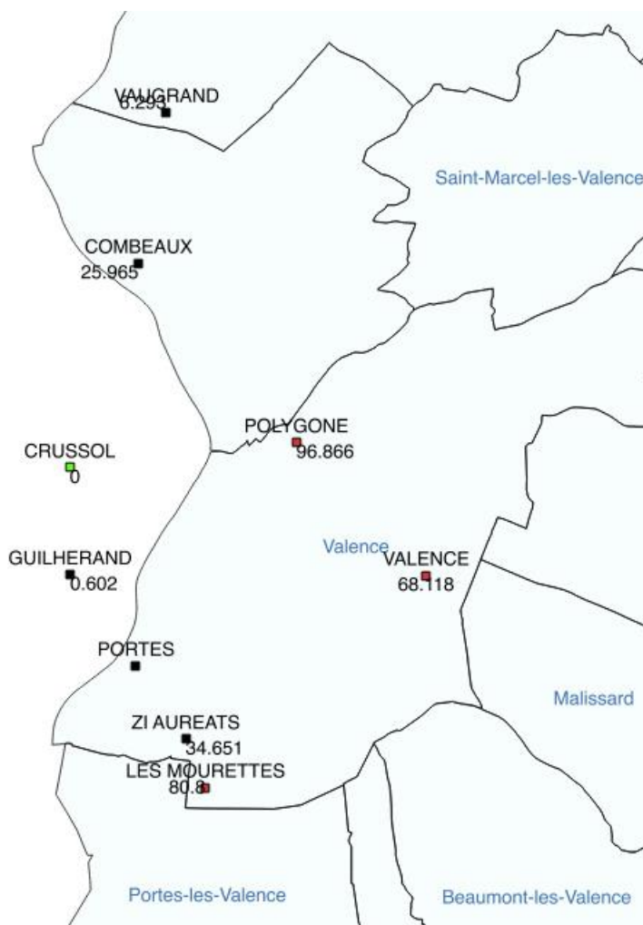
Figure 138 : Cartographie des postes sources et de la capacité EnR en MW qui leur est allouée si l'on considère le gisement plausible total (581MW), aux environs de Valence. Source : Hespul
